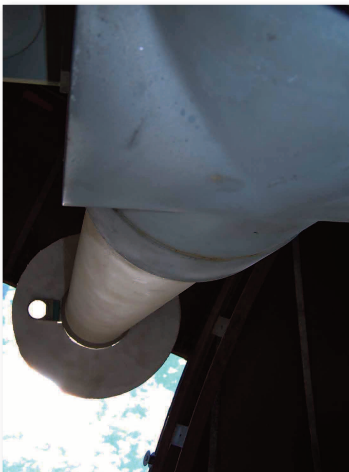
Il rifrattore da 15 centimetri con il quale ogni giorno, da più di mezzo secolo, viene effettuata l'osservazione fotosferica presso la Specola.
